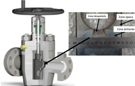
Fig. 1: Foto de la pieza desgastada.
