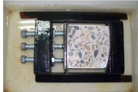
b) Durante el ensayo de succión capilar
