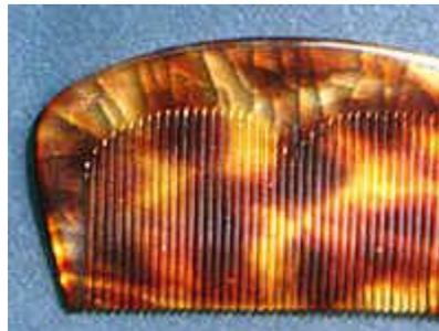
FIGURA 6 – *Crumbing* em peça de acetato de celulose.
