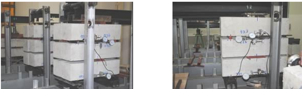
Figura 3: Probetas y dispositivos de medida empleados en los ensayos de fluencia.
