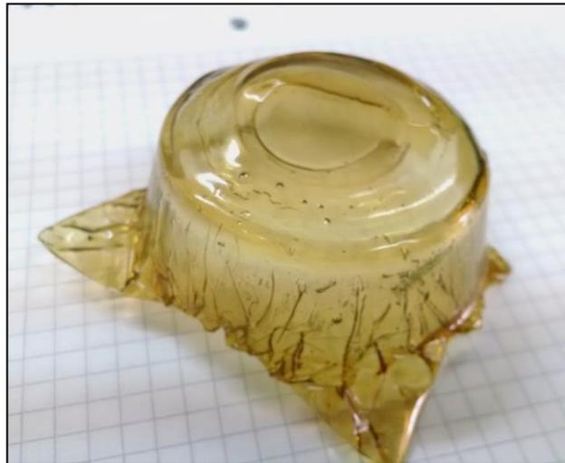
**Figura 8.** Recipiente obtenido a partir del termo-moldeado de una lámina prensada.
