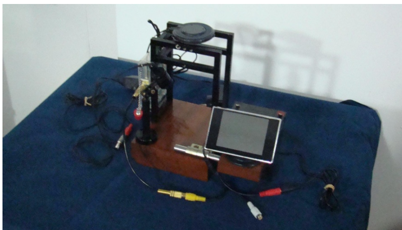
Figura 7. Dispositivo DLS compacto de bajo costo.
