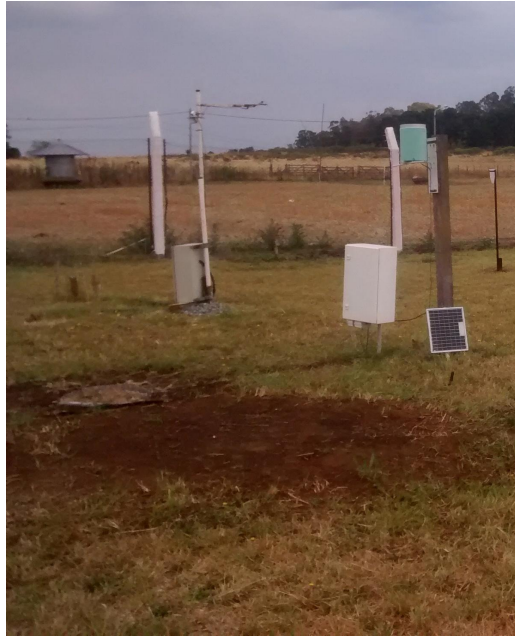
Figura 3. Estación del Lisímetro de Pesada. En la figura se observa el lisímetro y el gabinete que contiene el sistema de recolección de datos.
