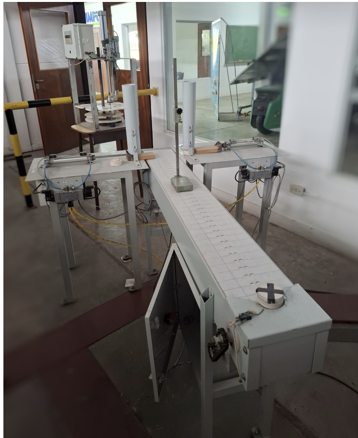
Figura 5.4: Celda de manufactura. Vista principal de cinta transportadora.
