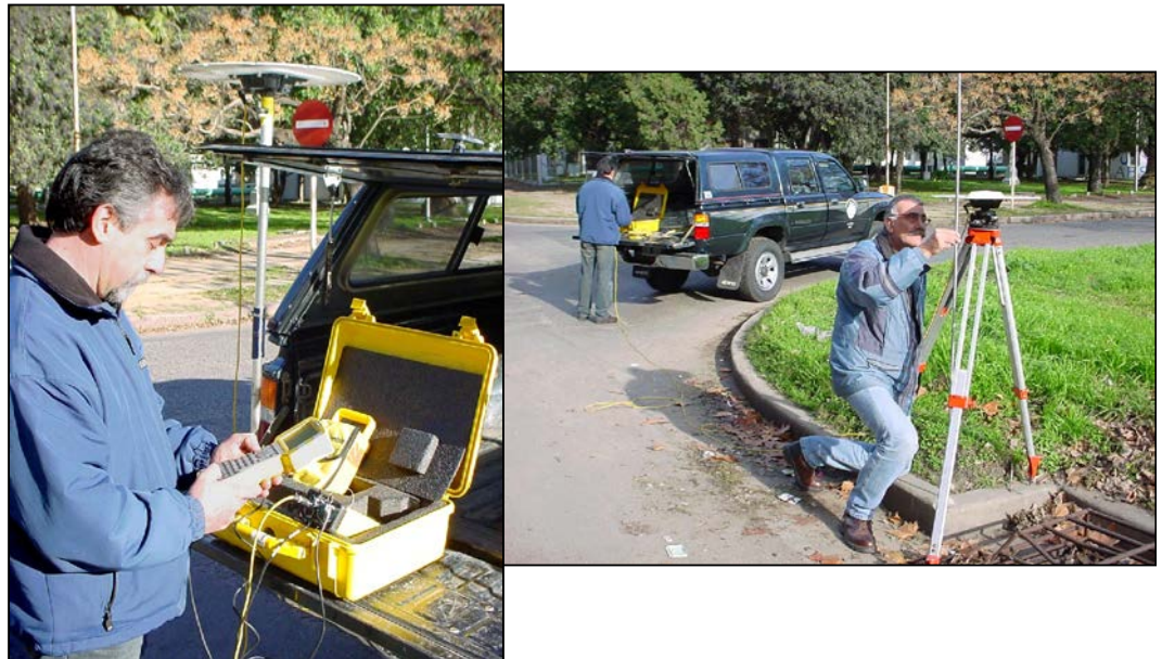
Foto 7.4: Relevamiento con sistema GPS de doble frecuencia.
