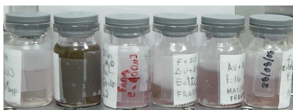
Fig IV.2.6.2 En las muestras se puede apreciar el enrojecimiento para diferentes fluencias. .
