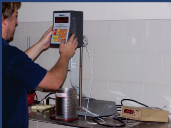
Equipo para determinar la viscosidad cinemática del asfalto.
