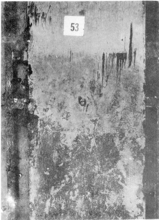
Fig. 7.- Pintura oleoresinosa 486 ( \text{Cu}_2\text{O}-\text{ZnO}-\text{AsO}_3\text{Cu}_3 ): fijación 1
