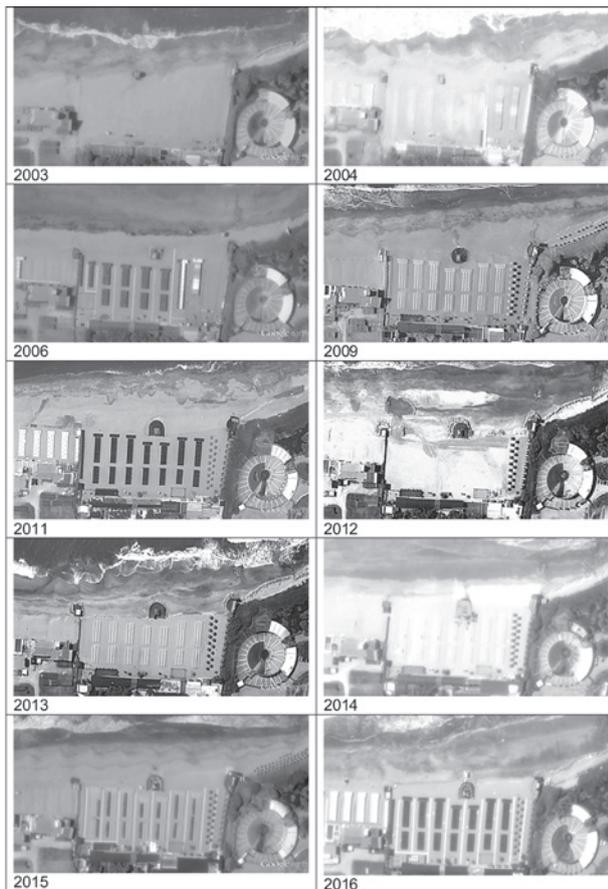
Figura 4: Evolución de la playa de Honu Beach. Obsérvese que a partir del 2009, la escarpa de playa se mantiene a los pies de las carpas. La solución, por parte del balneario, fue modificar el perfil de playa para adaptarlo a las exigencias del turismo. A partir del 2014 se observa, a la derecha del bar de playa, la arena de relleno (en un tono más claro). Para el 2016, la arena de relleno había sido erosionada en su totalidad.
