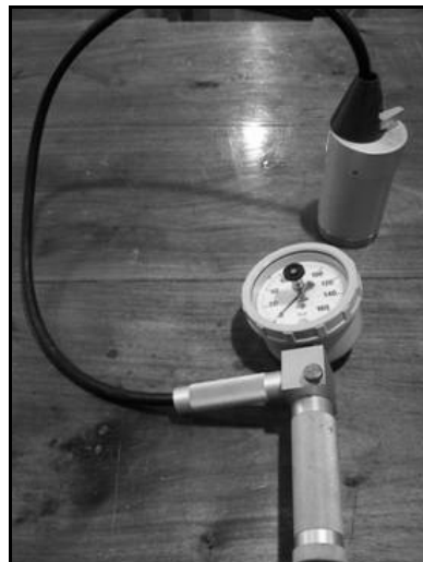
Figura 6.33 – Celda de carga, válvula de presión y manómetro del equipo Break-Off.
