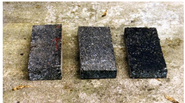
Fig. 9. Muestras (probetas) de superficies drenantes, similares a las calzadas de las autopistas estudiadas.
