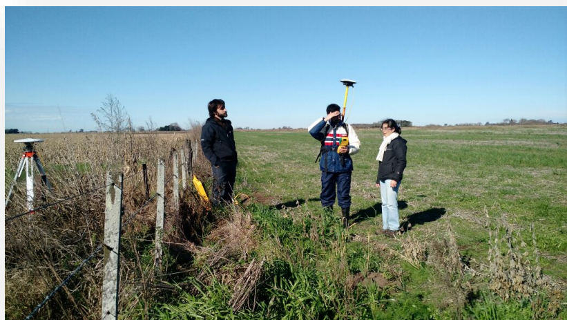
Figura B. 1. Trabajo de campo para levantamiento GPS. Fuente: Equipo de Geodesia de la Facultad de Ciencias Astronómicas y Geofísicas, UNLP.
