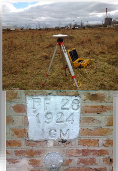
Figura B. 1. Trabajo de campo para levantamiento GPS. Fuente: Equipo de Geodesia de la Facultad de Ciencias Astronómicas y Geofísicas, UNLP.
