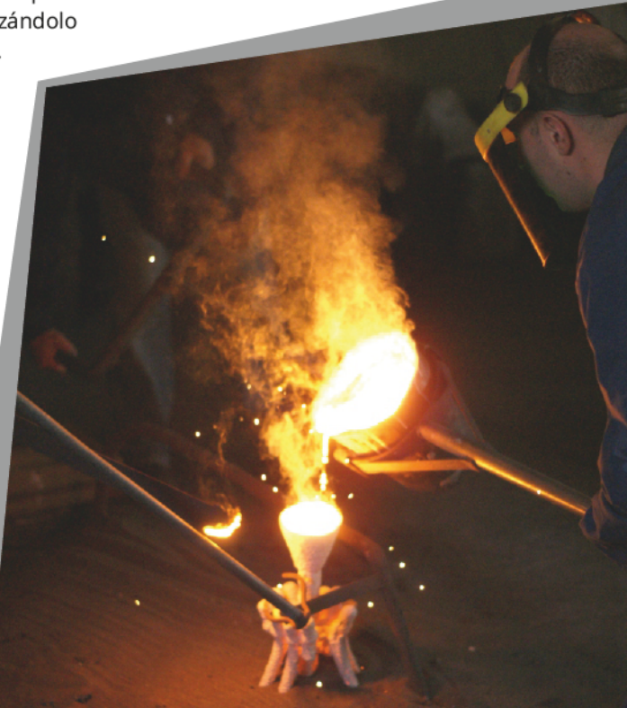
Trasvase de metal líquido del horno de fusión a la cuchara de colada
