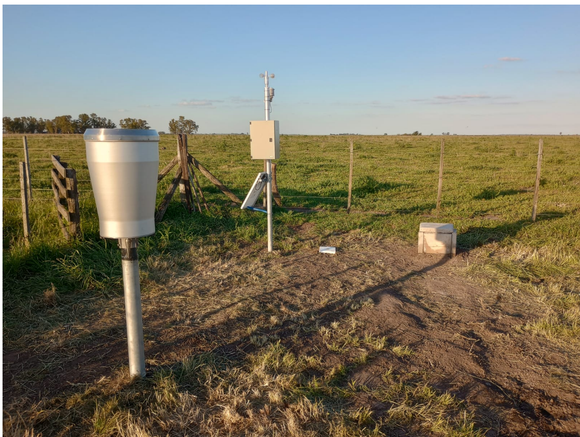
Figura 6: Instalación final de estación freaticométrica.
