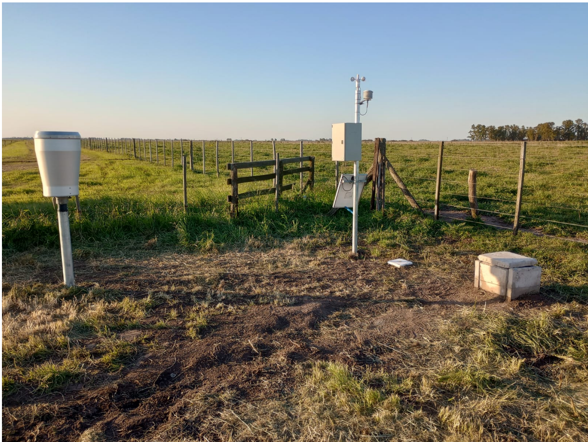
Figura 7: Disposición final de estación freatimétrica.
