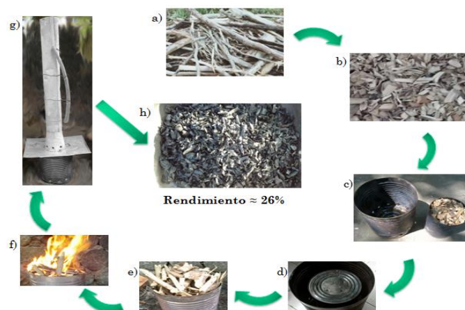
Figura 1: Esquema del método de carbonización. a) Si la biomasa tiene gran tamaño se la puede trozar con una máquina chipeadora resultando en b) . c) La biomasa se coloca en la lata pequeña. La lata grande posee una secuencia de agujeros en la parte inferior. d) La lata pequeña, la cual posee 3 agujeros en la tapa inferior, se coloca invertida en la lata más grande e) El espacio vacío entre medio de las dos latas se llena con madera seca. f) Se hace combustionar la madera con papel y un mechero. g) Luego de que la reacción se torna estable se coloca la chimenea y se lo alimenta con madera seca cuidando de que no se apague. h) La carbonización dura 2 hs.
