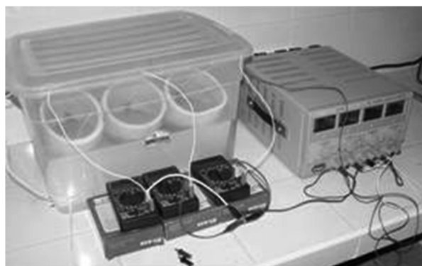
Figura 10. Ensayo de migración de cloruro.
