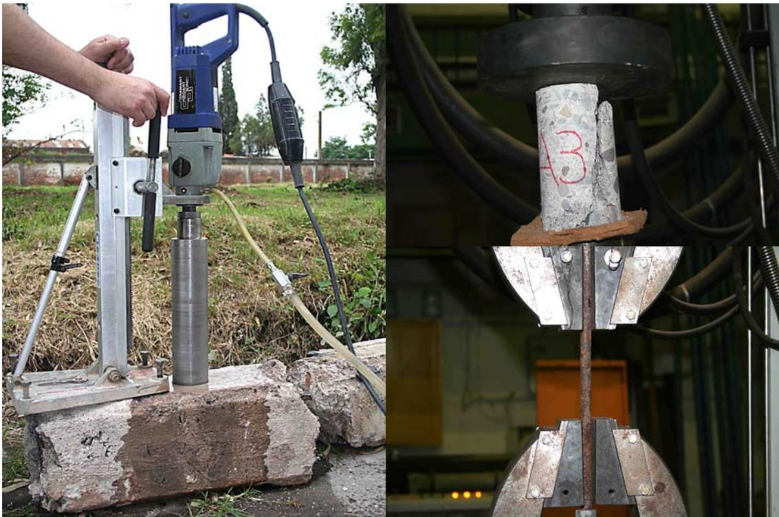
**Fotografía 17. Extracción y ensayos de resistencia de probetas de hormigón y acero en el Laboratorio del Instituto de Estructuras**
