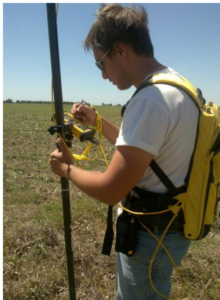
Ilustración 29 - Almacenamiento de datos en NOMAD 900 - Trimble PRO-XRT – Fuente: Elaboración propia
