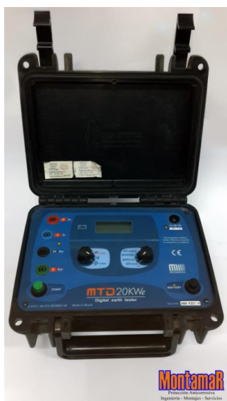
Ilustración 15 - Resistivímetro Megabras 20 MTD20Kwe – Fuente: Elaboración propia
