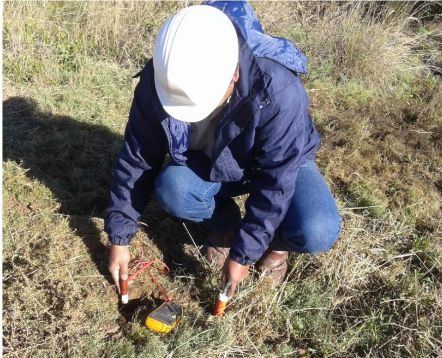
Ilustración 28 - Medición de pH en terreno – Fuente: Elaboración propia
