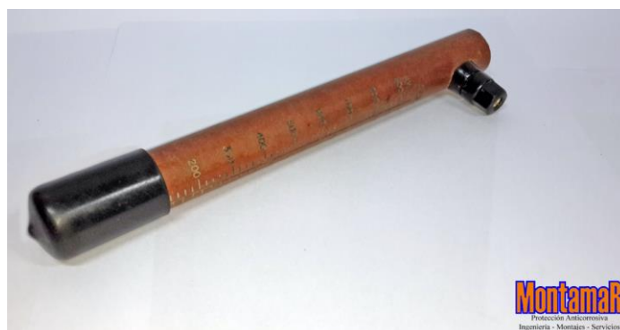
Ilustración 16 - Electrodo de antimonio – Fuente: Elaboración propia
