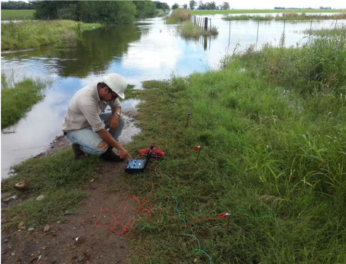
Ilustración 27 - Medición de resistividad zona anegada – Fuente: Elaboración propia
