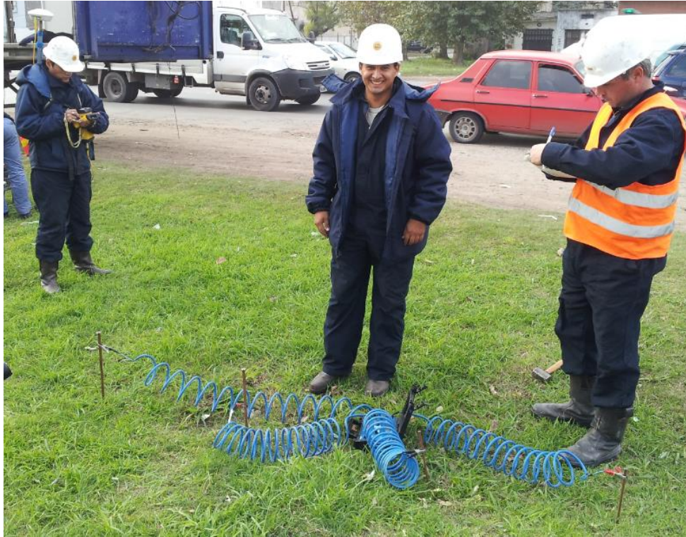
Ilustración 26 - Medición de resistividad en campo
