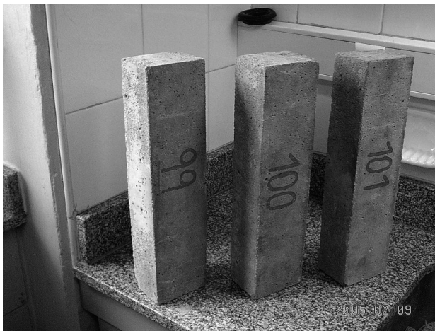
Figura 18: Hormigón reciclado (HR-100).
