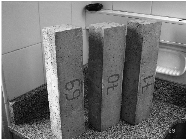
Figura 16: Hormigón reciclado (HR-50).
