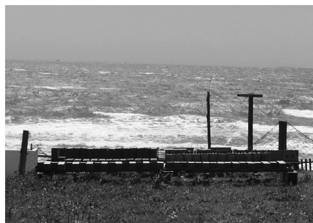
Figura 13: Muestras de hormigón expuestas en ambiente marino
