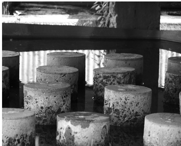
Detalle de las afectaciones producidas por sulfatos en muestras enterradas en suelos contaminados con sulfatos.
