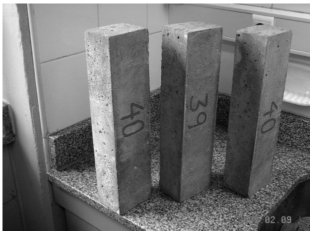
Figura 17: Hormigón reciclado (HR-75).
