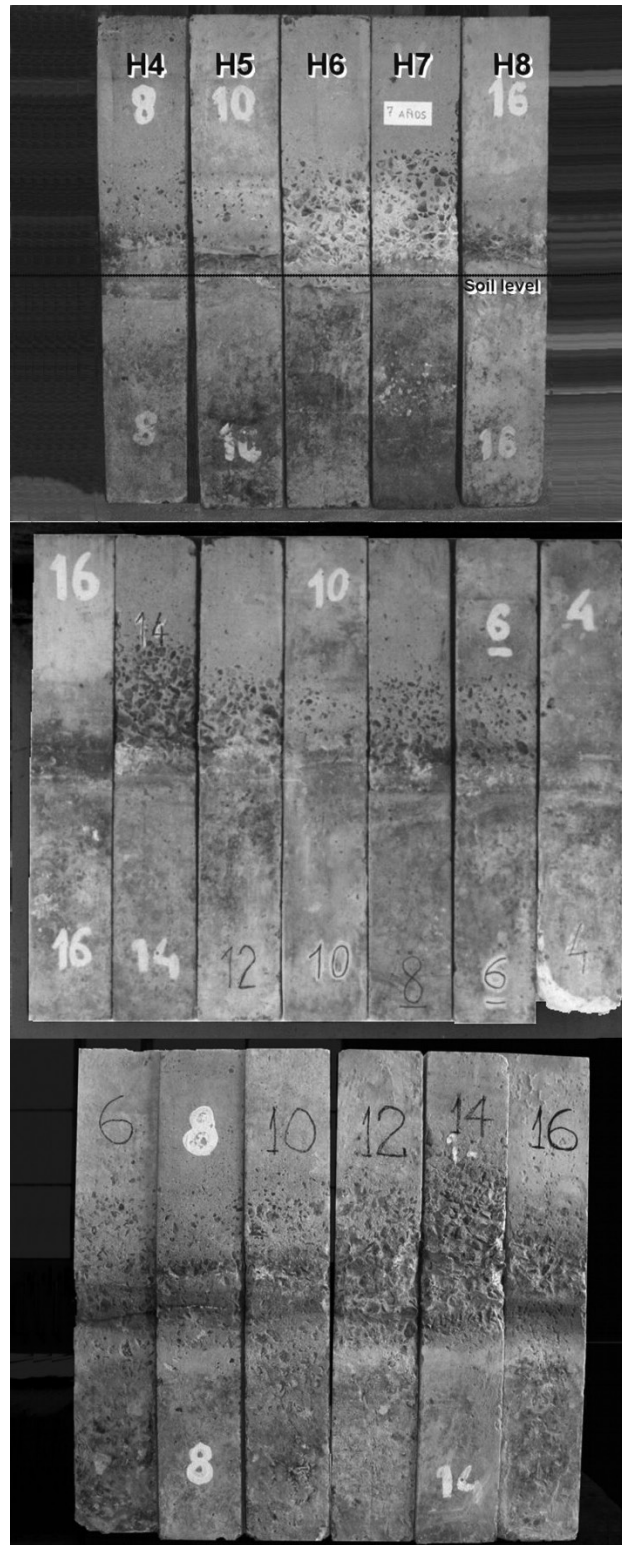
Figura 7: Fotografía del deterioro de las vigas a los 7, 10 y 22 años.
