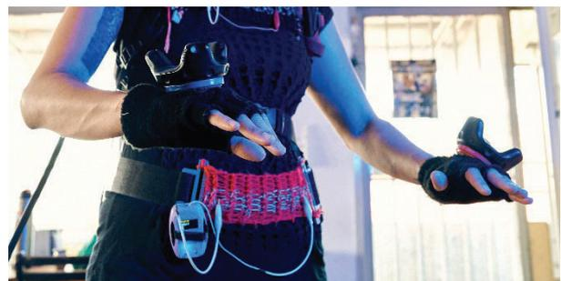
Figura 3 Detalle de control tejido con lana conductiva
