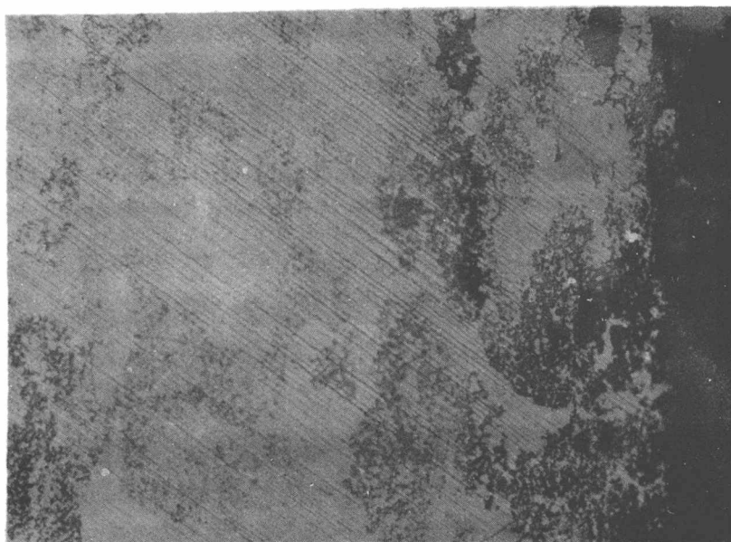
Fig. 3.- Muestra n° 2, procedencia nacional; corroída originalmente, no se ensayó (390 X)
