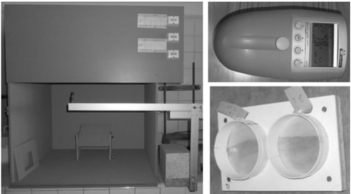
Figura 1. Inspección visual (izquierda); BYK Gardner (derecha arriba); molde de madera (derecha abajo).
