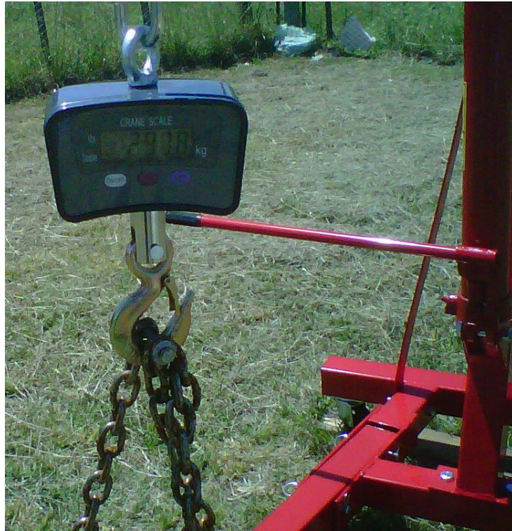
Figura 5. Balanza acoplada a la pluma hidráulica
