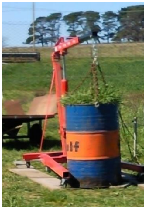
Figura 7. Lisímetro de pesada suspendido mediante una pluma hidráulica
