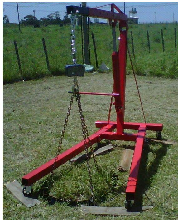
Figura 6. Pluma hidráulica acoplada a la balanza que sostiene las cadenas del Lisímetro
