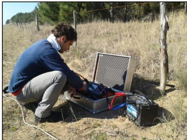
*Fig. 4.13 Resistivímetro ARES II utilizado para la medición de tomografías eléctricas, con un cable multinúcleo de 28 conectores controlado por la caja conmutadora.*
