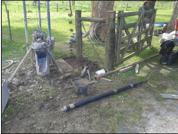
*Fig. 4.12 Sonda para el registro geofísico de pozo. La herramienta cuenta con un sensor de radiación gamma natural y electrodos de cobre dispuestos para registrar con los arreglos Normal Corta (16"), Normal Larga (64") y Lateral.*
