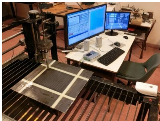
Figura 3.26. Tribómetro de desgaste de alta presión. Sistema “Pin on Table”
