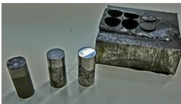
Figura 3.27. Extracción de muestras por corte por hilo.
