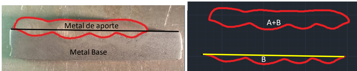
Figura 3.10. Calculo de dilución en cordones de multipasadas.
