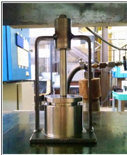
Figura 2. Dispositivo especialmente construido empleado para el moldeo.
