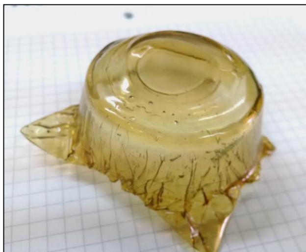
Figura 8. Recipiente obtenido a partir del termo-moldeo de una lámina prensada.
