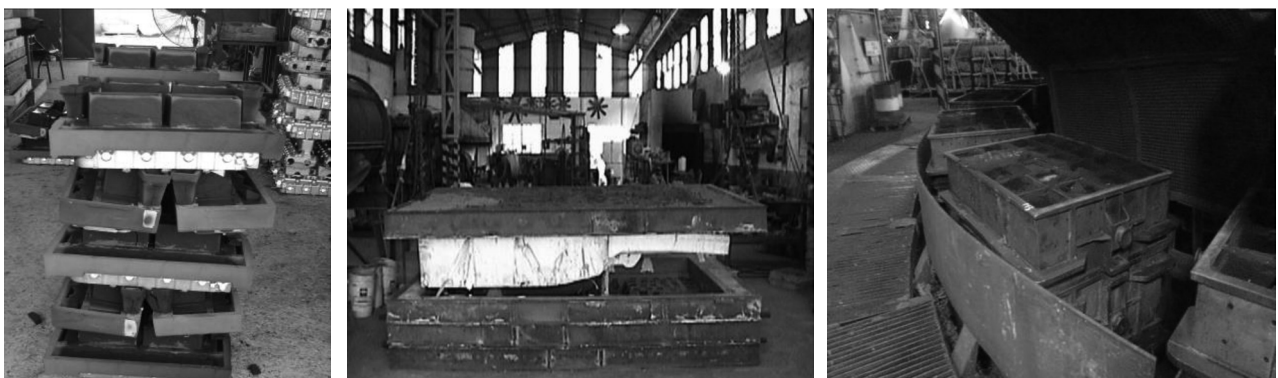
Fig. 1. Moldes de fundición confeccionados con distintos aglomerantes a) Shell, b) Arena verde (arcilla) y c) Alkid uretánico.
