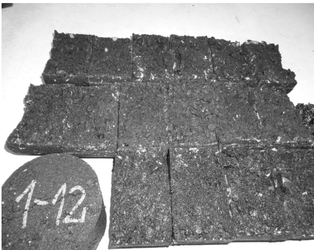
Figura 7. Probetas sometidas a distintos ciclos de Daño por humedad.
