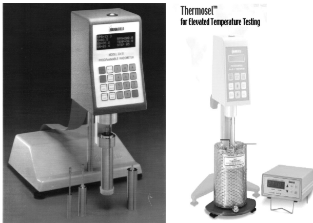
Figura 4: Viscosímetro rotacional con diversos rotores (Izq.) Celda térmica para ensayos a temperaturas elevadas (Der.)
