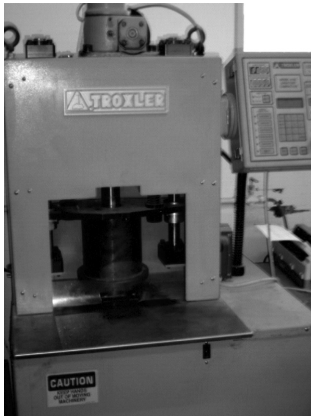
Gráfico 2. Compactador giratorio Superpave. Detalle del proceso de compactación.
