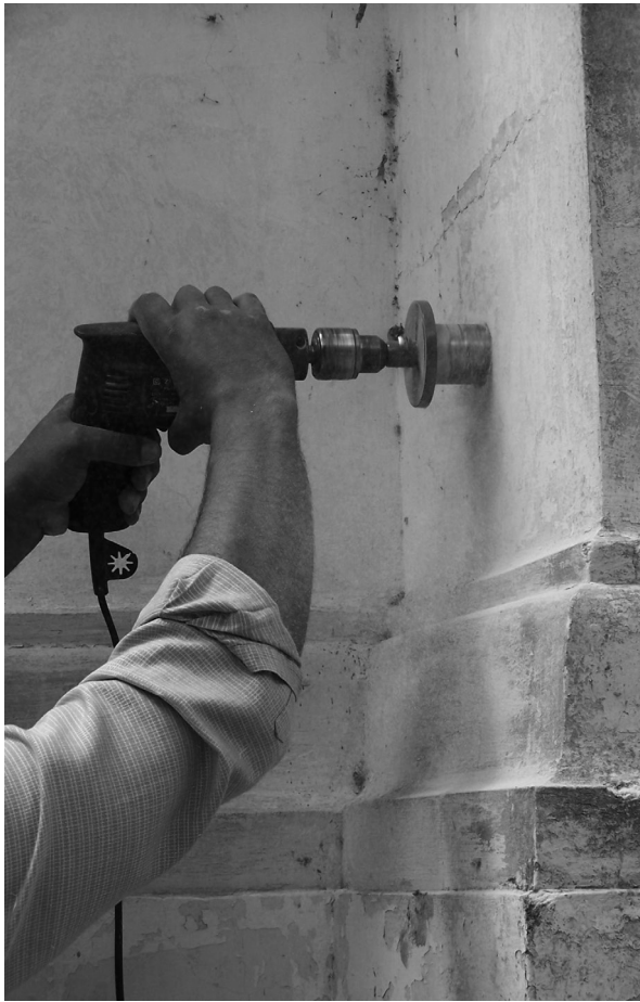
Imagen 6: Vista del proceso de extracción, muestras obtenidas y del pequeño orificio residual.
