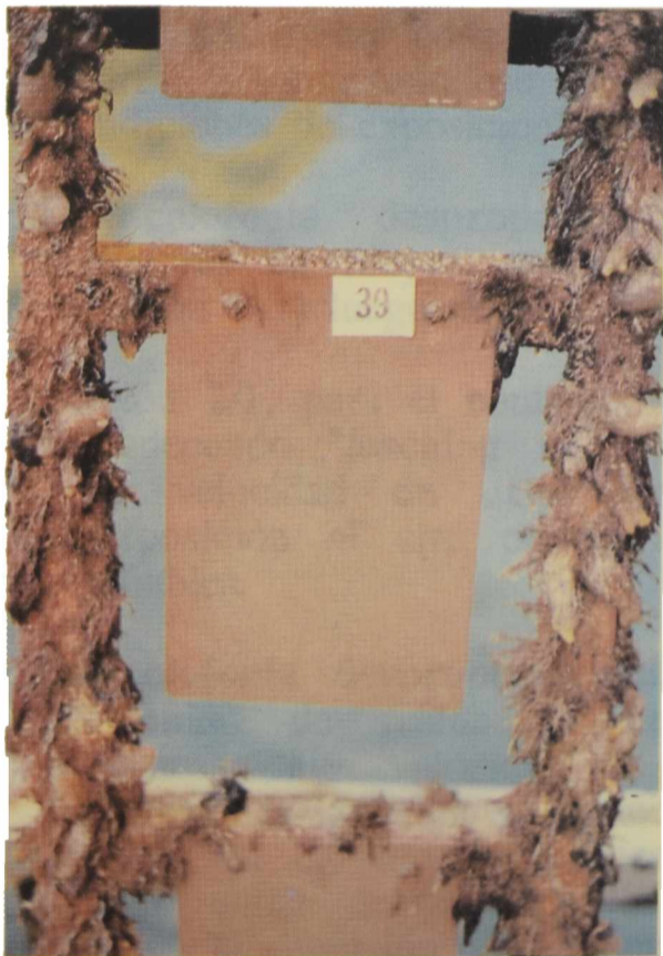
Fig. 2.- Pintura basada en resina colofonia original (relación 2/1), 24 horas de exposición al aire antes de la inmersión, 36 meses de ensayo.
