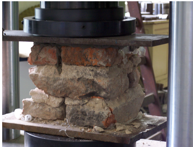
Figura 2. Ensayo a Compresión de Testigo de mampostería
