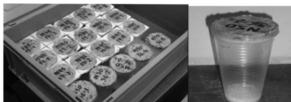
Figura 7. Determinaciones de difusión de humedad.
