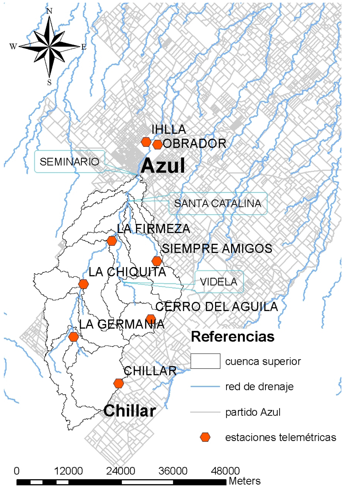
Figura N°1 | Estaciones telemétricas y limnimétricas de la red de monitoreo del IHLLA.
