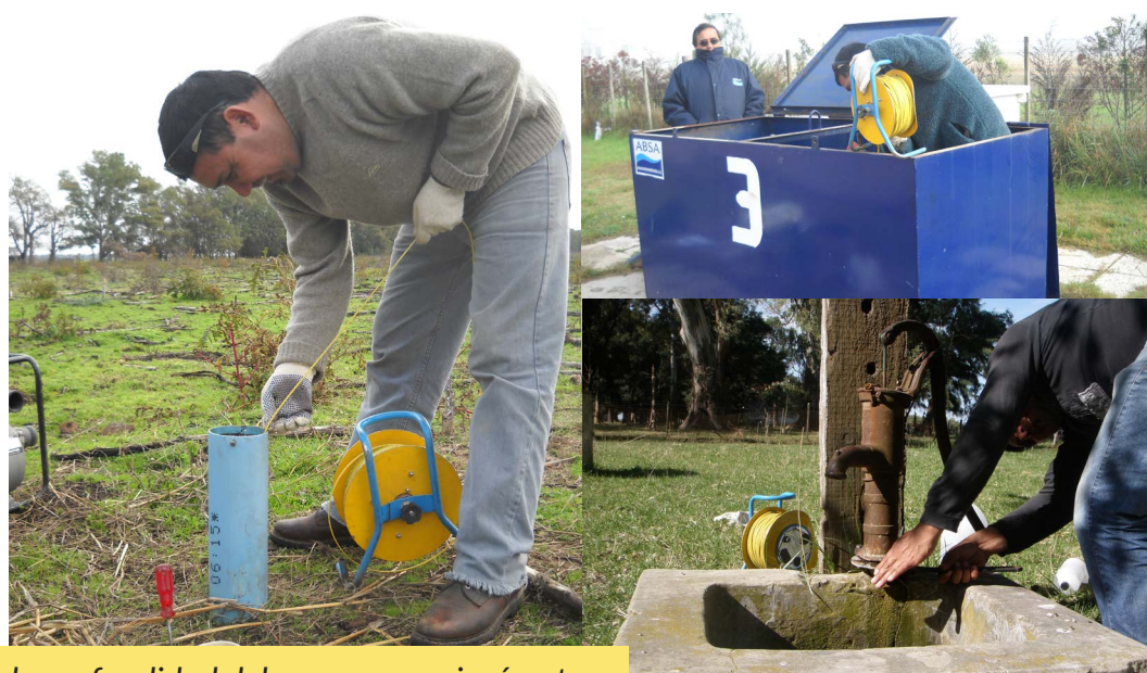
Figura N°1 | Medición de la profundidad del agua en un piezómetro, en un pozo de explotación, en una bomba sapo y en un molino.
