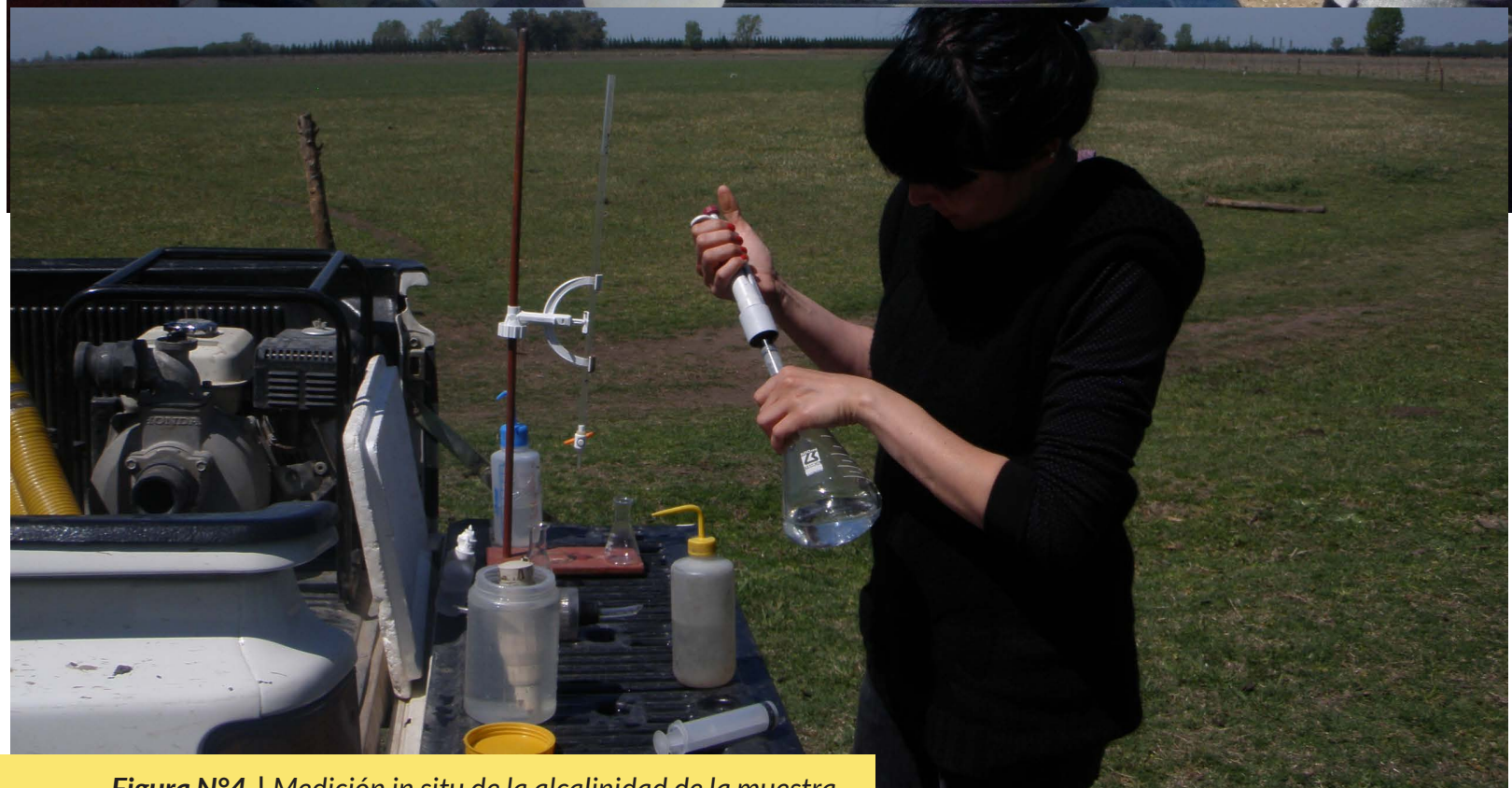
Figura N°4 | Medición in situ de la alcalinidad de la muestra.
