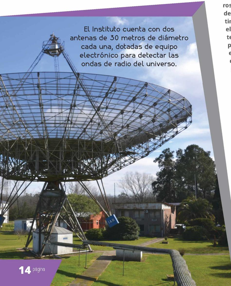
El Instituto cuenta con dos antenas de 30 metros de diámetro cada una, dotadas de equipo electrónico para detectar las ondas de radio del universo.
