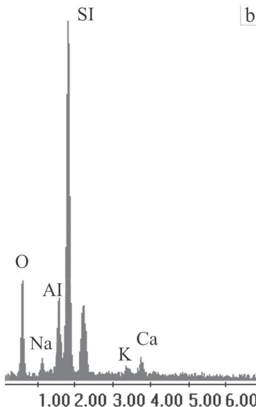
Figura 4. a. Microscopia electrónica de barrido. b. EDAX de la ceolita observada en la figura a.
