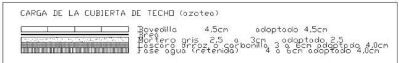
Figura 14: Configuración original de cubierta.
