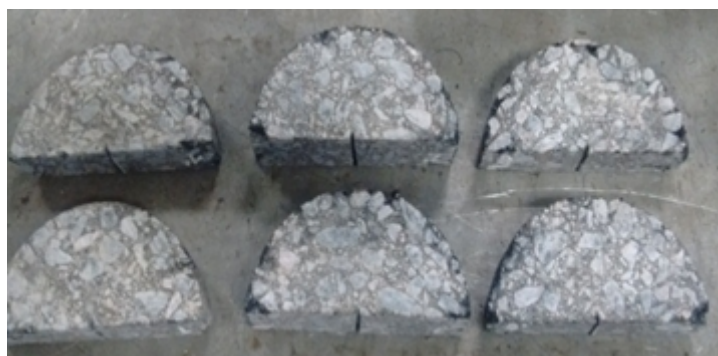
FIGURA 19 Distribución de áridos probetas centrales.
