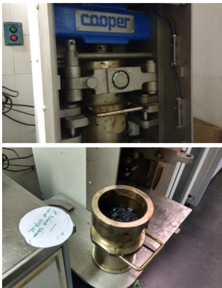
FIGURA 1 Compactador Giratorio de YPF; Mezcla MA1.
