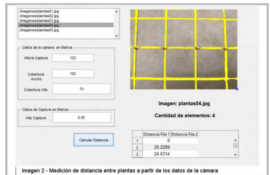
Imagen 2 - Medición de distancia entre plantas a partir de los datos de la cámara
