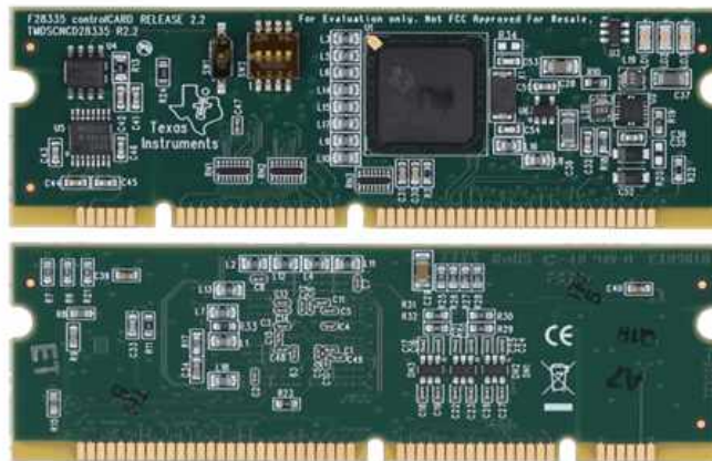
Figura 3.6: Controlador digital de señales modelo TMS320F28335 de la línea C2000.
