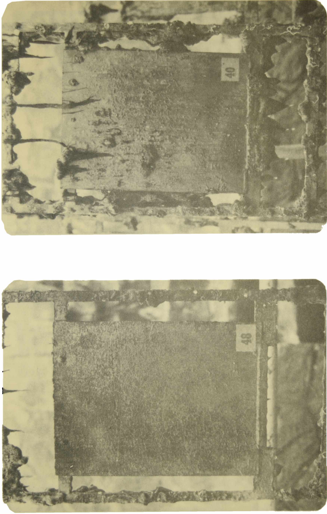
Fig. 5.- Influencia del coloides protector sobre el comportamiento antiincrustante: izquierda, almidón de maíz; derecha, caseína
