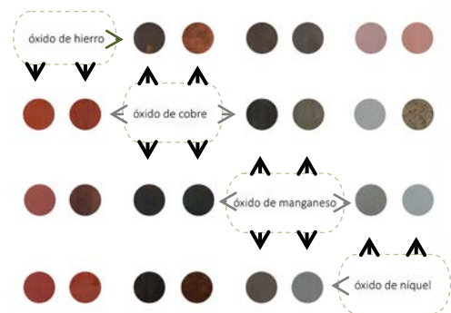
Fig. 1: mapa de color obtenido. Las columnas corresponden al óxido principal (9 y 7) y las filas al secundario (1 y 3)
