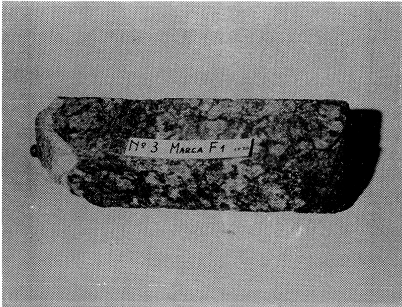
Fig. 15.- Detalle del ataque por acción del agua de mar, en una probeta luego de un año de inmersión.
