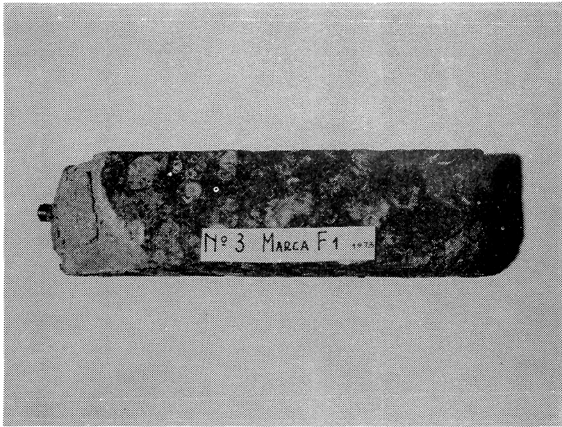
Fig. 14.- Detalle del ataque por acción del agua de mar en una probeta luego de un año de inmersión.
