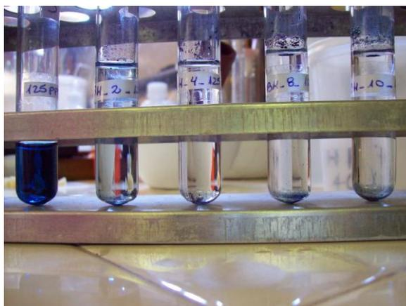
Figura 1: Diferentes cantidades de BH para la retención del colorante NA.
