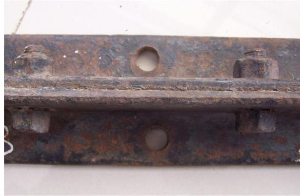
**Fotografía 4: Pieza metálica. Se observa la unión de dos perfiles ángulo mediante bulones.**
