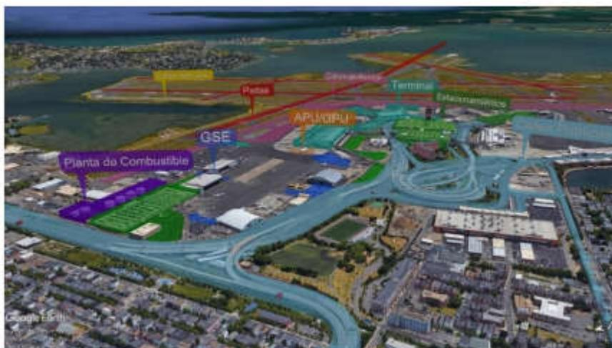
Figura 1. Principales fuentes de emisiones gaseosas contaminantes en un aeropuerto.
