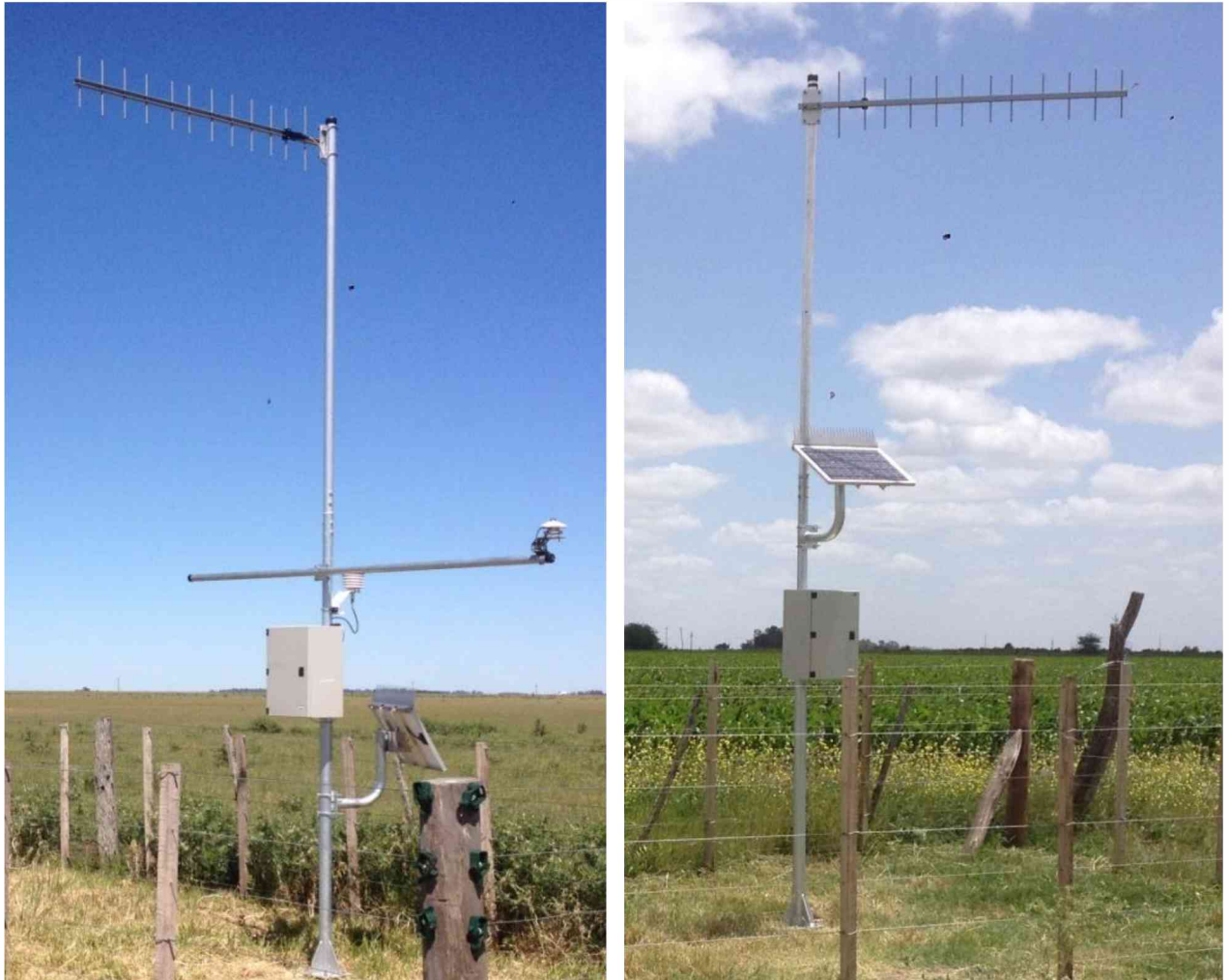
Figura 18. Antena de 12 Elementos HD Yagi modelo RK-A12U de 490-512MHz, 300 Watt, 12dBd con diferente orientación ubicada en la torre meteorológica a una altura de 4,5 metros.
