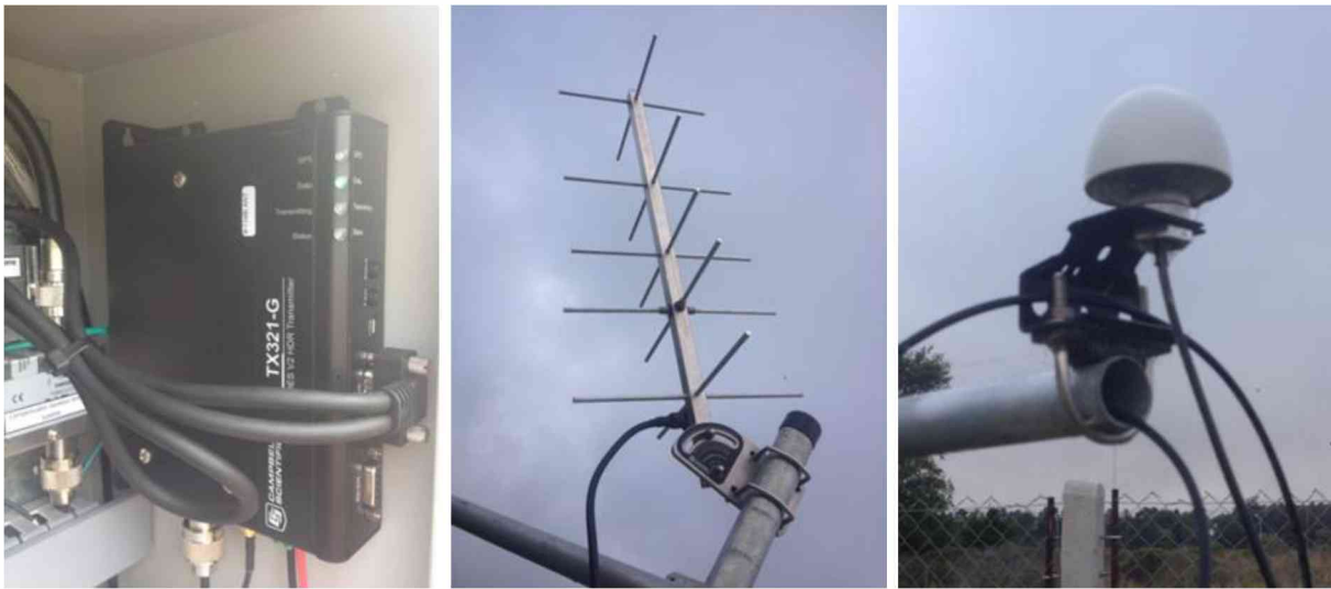
Figura 19. Transmisor (izquierda), antena Yagi (centro) y GPS (derecha).
