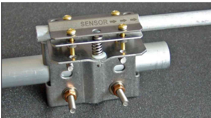
Figura 2-2. Sujeción del CNR4 con el soporte (np:26120) en el travesaño.
