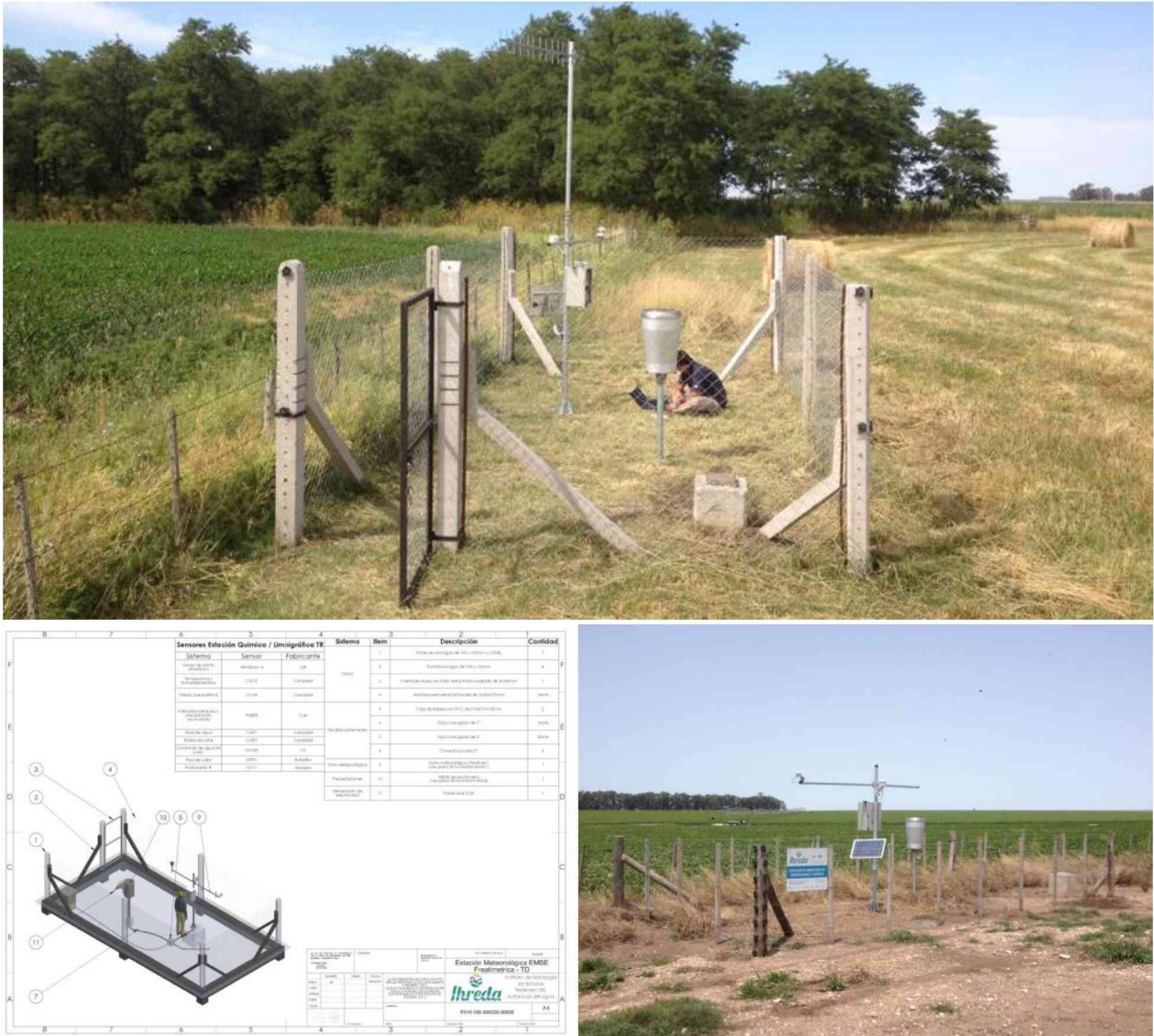
Figura 7. Modelo de 8 metros por 4 metros. EM35 de alambre romboidal y transmisión en tiempo real por onda de radio (arriba); EM30 de alambre de hilos en zona de ganadería con transmisión 3G (abajo derecha). Ambas estaciones con pluviómetro, sensores de temperatura y humedad del aire, radiación neta y freatímetro. Plano en Solid Work y esquema de estación modelo (abajo izquierda).
