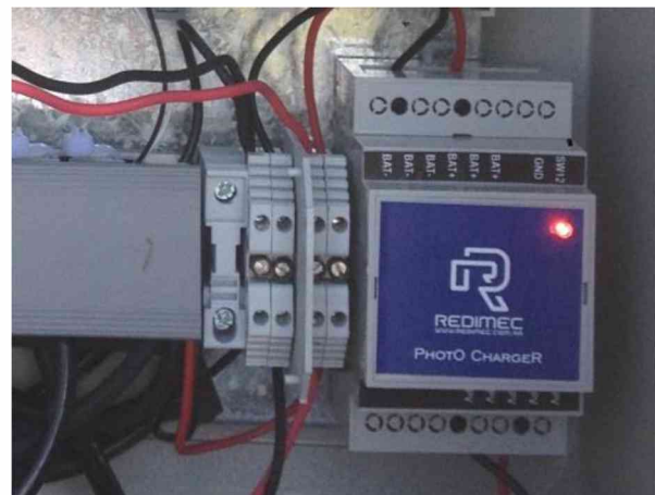
Figura 16. Cargador variable diseñado por Redimec SRL.
