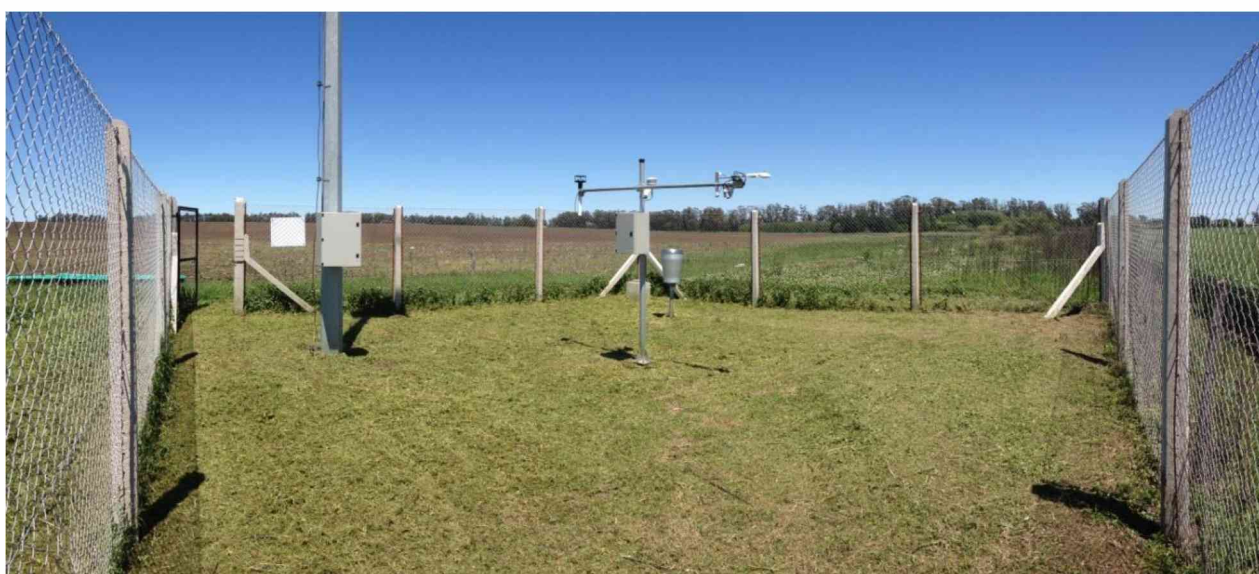
Figura 5a. Fotos de EM45 en parcela de 10 metros por 10 metros de alambre romboidal, pluviómetro, freatímetro, sensores de radiación neta con torre de transmisión de 10 metros de altura.
