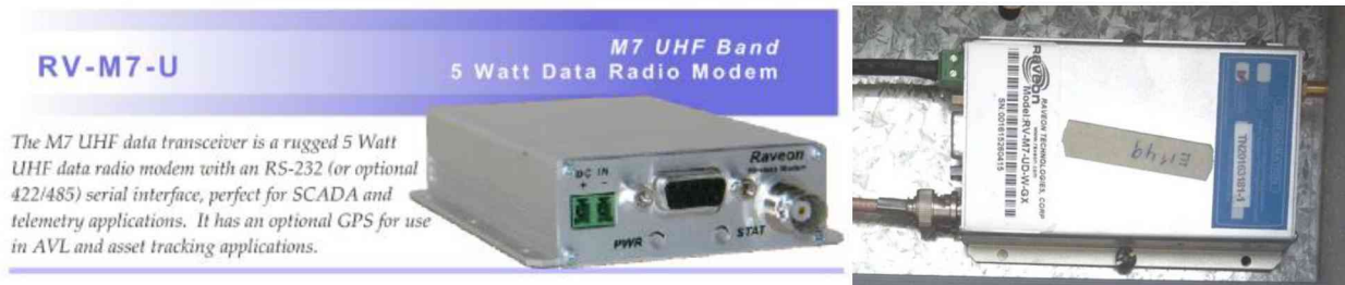
Figura 17. Radio utilizada para la transmisión de datos con potencia menor a 5 W (cumple normativa ambiental).
