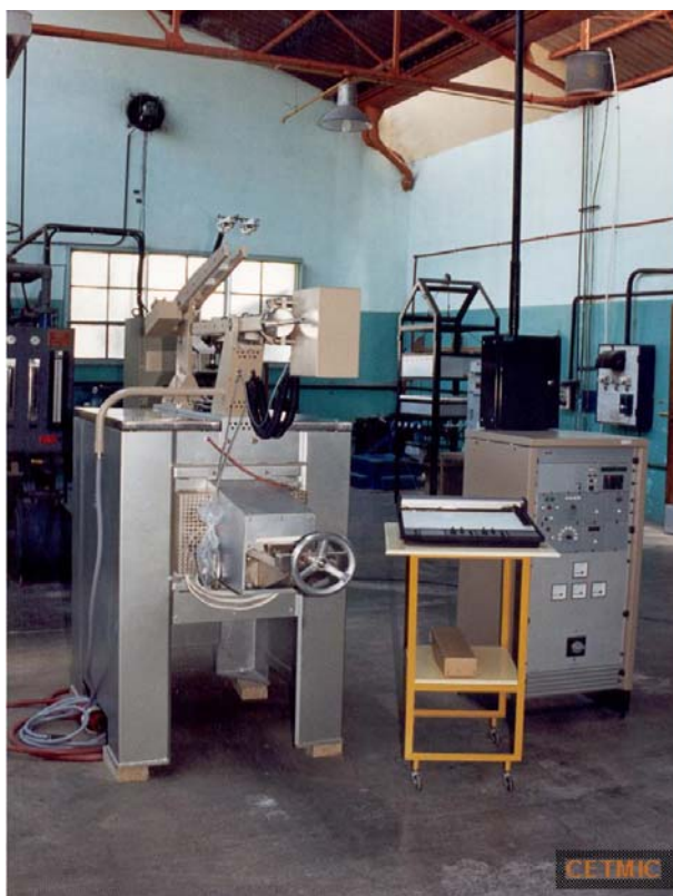
Figura 3.16: Equipo para medición del módulo de rotura en caliente.
