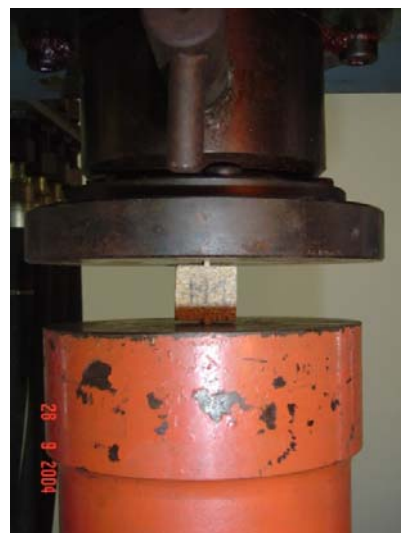
Figura 3.18: Ensayo de compresión diametral: Vista de la máquina y probeta utilizada
