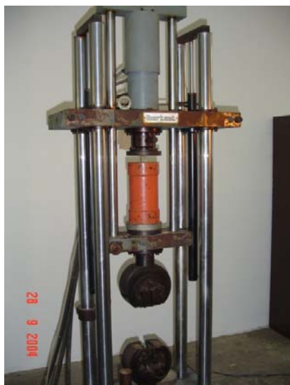
Figura 3.18: Ensayo de compresión diametral: Vista de la máquina y probeta utilizada
